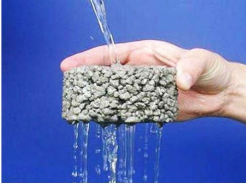
**高效透水** 抗压、抗折和抗冻性能可完全达到普通混凝土的物理性能的同时而又能高效透水，其透水率远远超过透水砖，通常情况下需要达到一桶水在5秒内完全渗透的水平，路面的高透水性使其在通常环境下保持5-10年高透水率。
